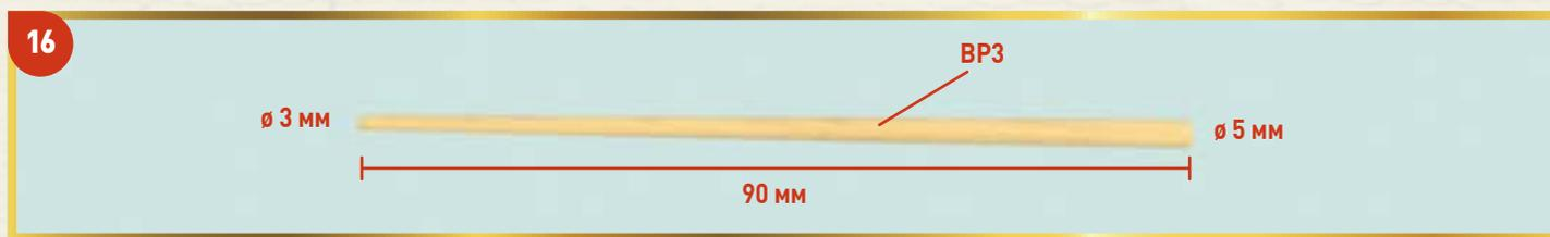
**16** Наконец, возьмите стержень  $\varnothing 5$  x 300 мм, который вы получили с выпуском 78. Отрежьте от него фрагмент длиной 90 мм и заузьте его так, чтобы диаметр одного его конца составлял 5 мм, а другого — 3 мм. Пометьте эту деталь как BP3. Сохраните неиспользованный фрагмент стержня.
