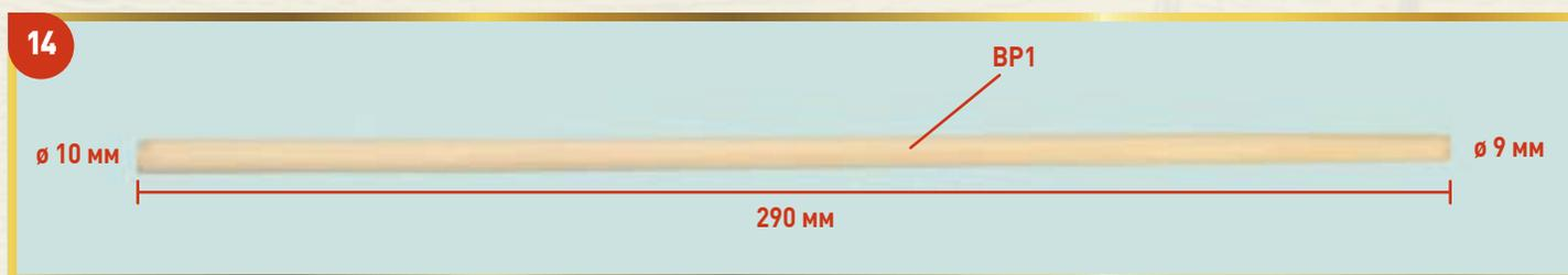
**14** Возьмите стержень  $\varnothing 10$  мм и длиной 300 мм, который вы получили с выпуском 78. Отрежьте от него фрагмент длиной 290 мм и слегка заузьте его так, чтобы диаметр одного его конца составлял 10 мм, а другого — 9 мм. Пометьте эту деталь как BP1.
