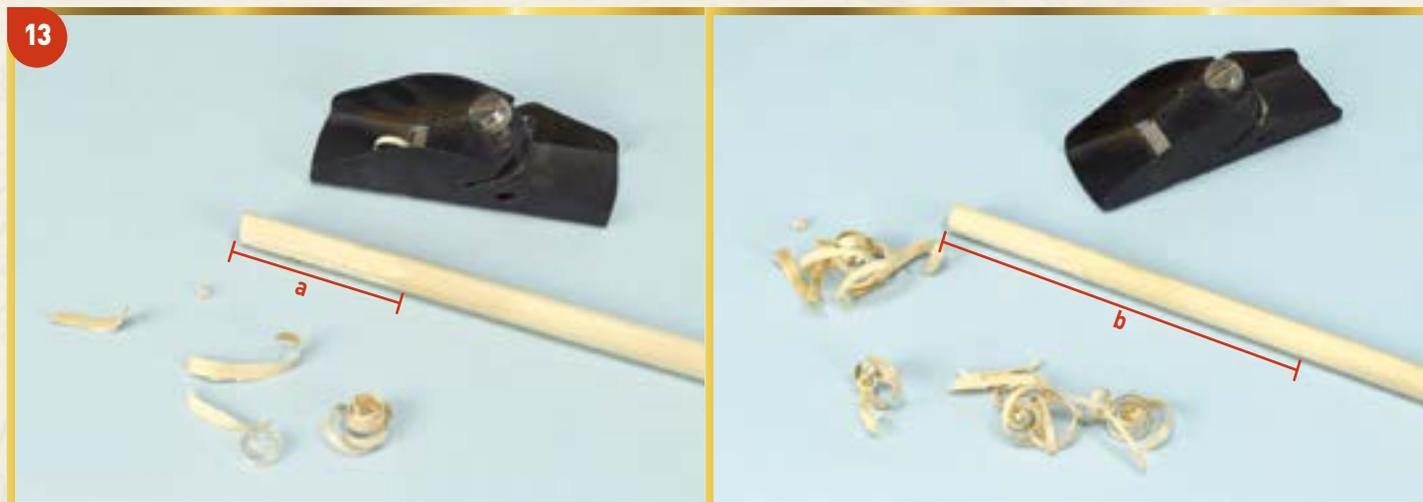
**13** Способ 3. Воспользуйтесь небольшим рубанком, работая поочередно над одной из сторон стержня и соединяя готовые стороны друг с другом. В завершение обработайте стержень наждачной бумагой (см. способ 1).
