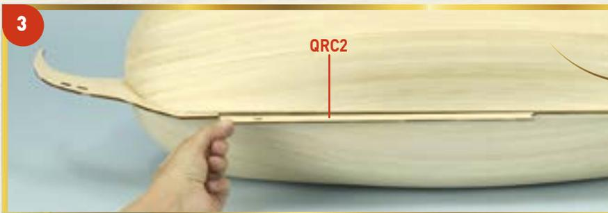
**3** Извлеките из деревянной матрицы деталь QRC2. Вставьте ее в паз, расположенный в дне модели, и приклейте эту деталь вплотную к концу детали QRC1a.
